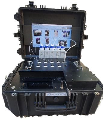
L'analyseur fonctionne comme une imprimante avec **une cartouche spécifique** par paramètre analytique.
